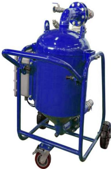
El Mini Limpiador de Vacío GN está diseñado para trabajos de limpieza industrial exigentes. Las herramientas de succión móviles y livianas lo hacen eficiente en su funcionamiento. El limpiador funciona con aire para producir un alto vacío durante la succión y puede cambiar manualmente a presión positiva para la descarga. Además, los operadores pueden configurar el tiempo de succión y descarga para que realice estas funciones automáticamente.
