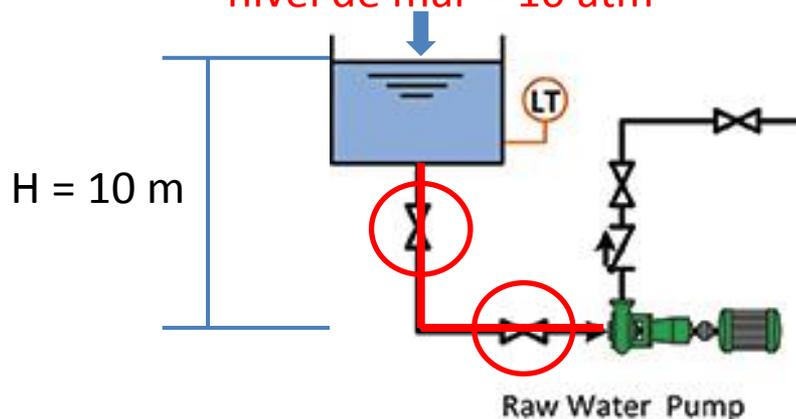
$P = 0.5\text{ m}$  por el largo de la cañería calculado con el caudal que va a mover la bomba (mas caudal = mas perdida de carga)
