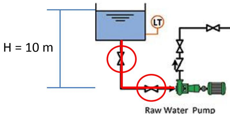
$P = 0.5\text{ m}$  por el largo de la cañería calculado con el caudal que va a mover la bomba (mas caudal = mas perdida de carga)
