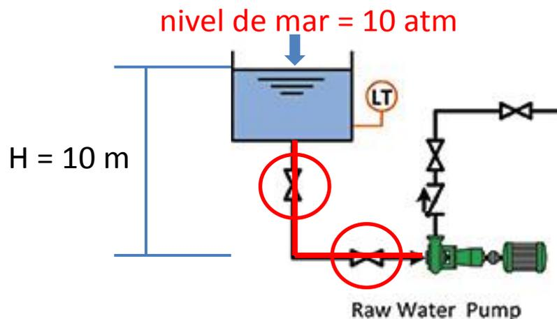
P = 0.5 m por el largo de la cañería calculado con el caudal que va a mover la bomba (mas caudal = mas perdida de carga)
