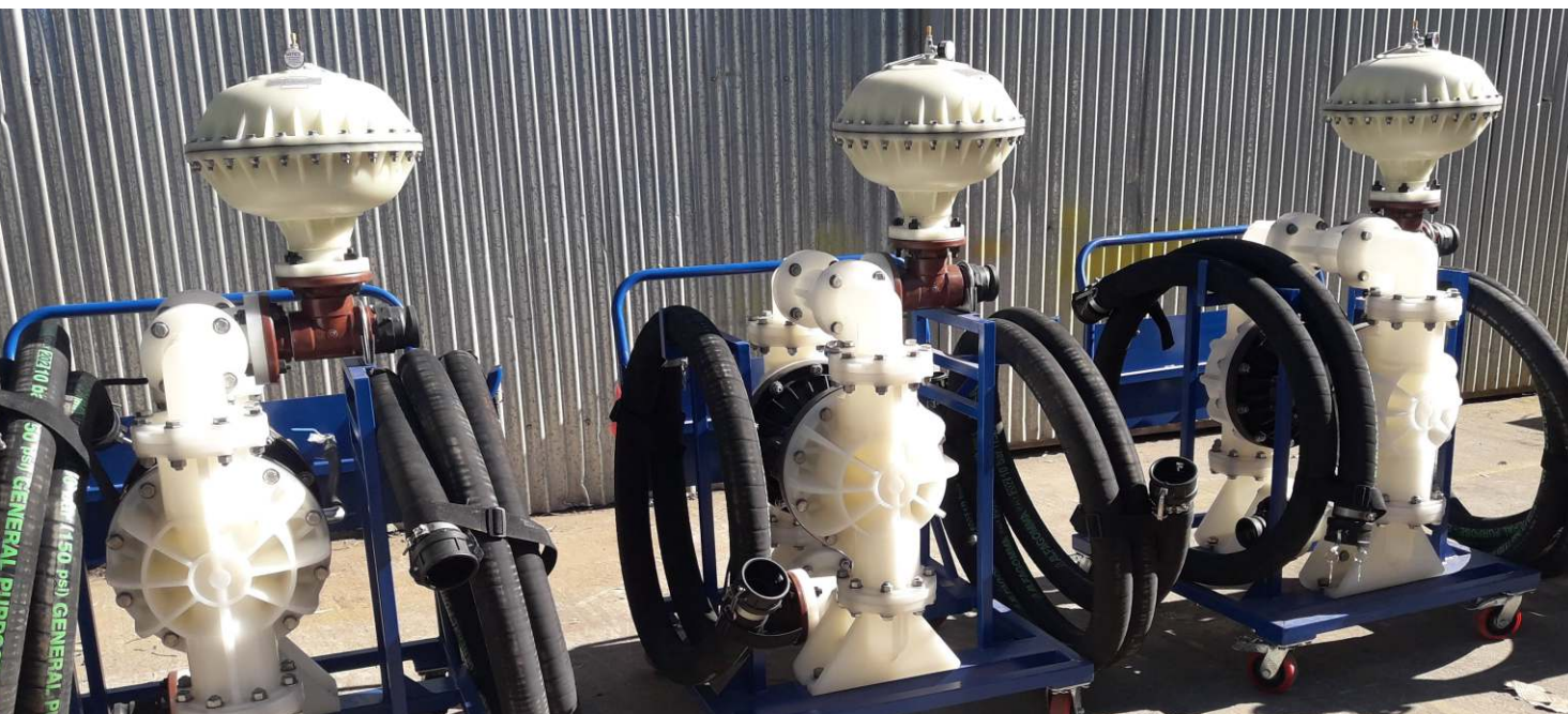
Opciones de bombas neumáticas de doble diafragma para el movimiento de fluidos corrosivos, abrasivos, y/o inflamables.
