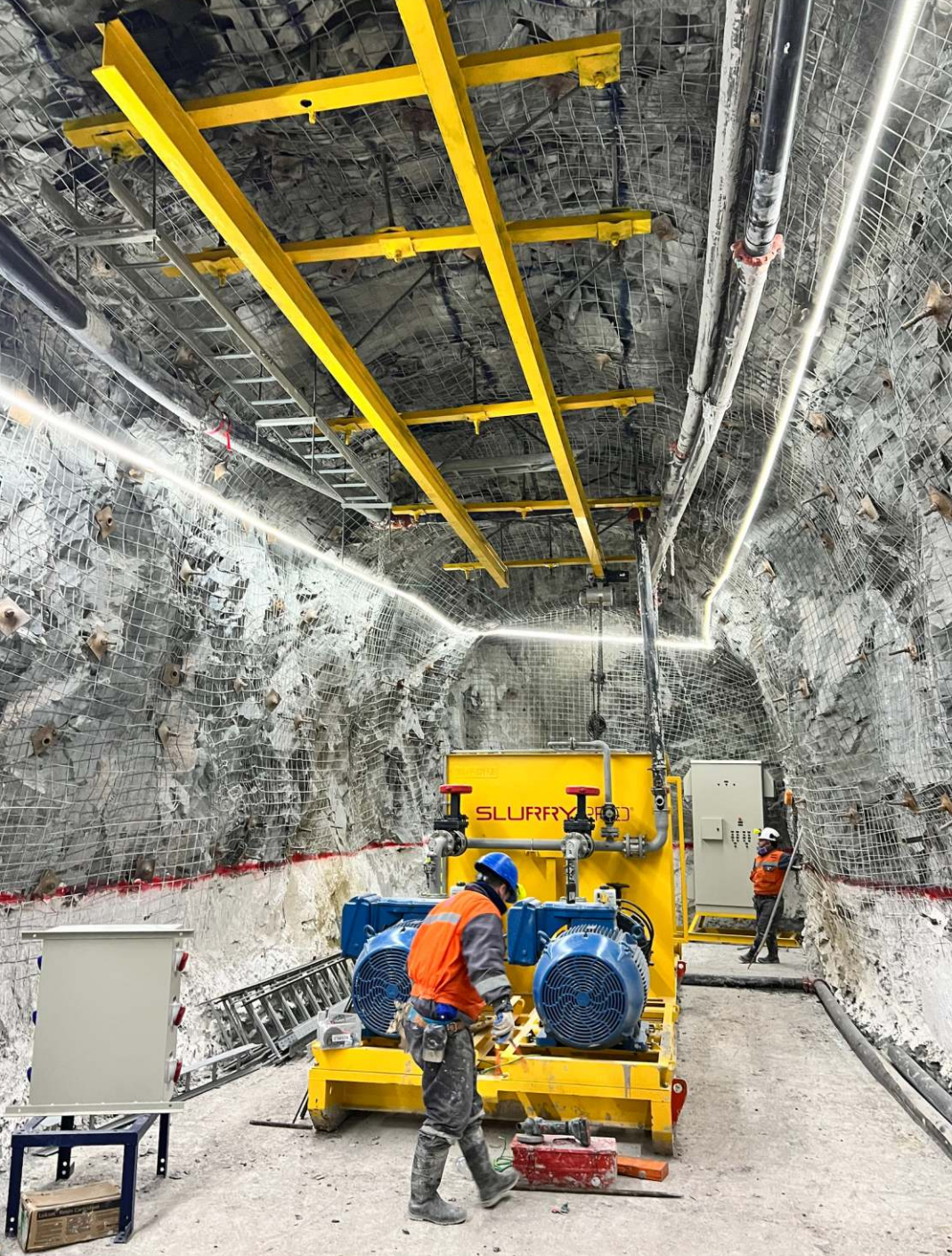
Estaciones móviles de bombeo para desagüe de mina subterránea.
