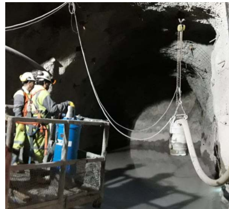
Opciones de bombas sumergibles para desagüe y drenaje de fluidos abrasivos y con sólidos en suspensión.
