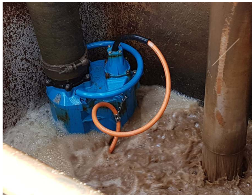
Opciones de bombas sumergibles para desagüe y drenaje de fluidos abrasivos y con sólidos en suspensión.
