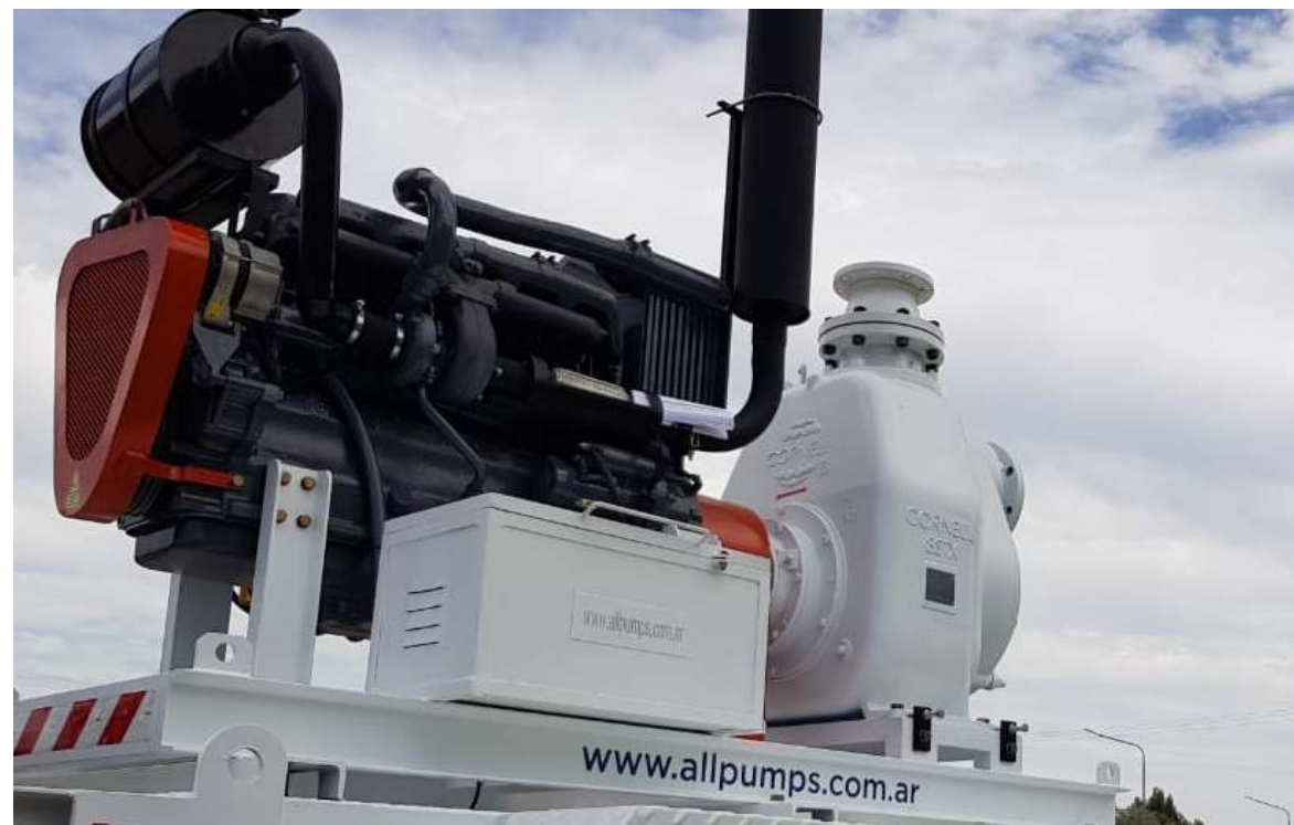
Opciones de bombas autocebantes para fluidos abrasivos, cristalizantes y con partículas en suspensión.
