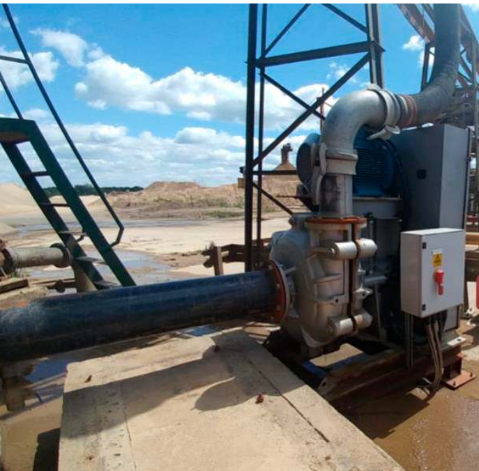
Opciones de bombas centrífugas horizontales y verticales para movimiento de lodos.
