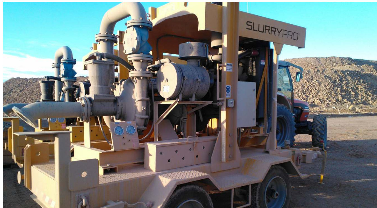
Sistemas de bombeo para servicio de desagüe de minas y canteras.
