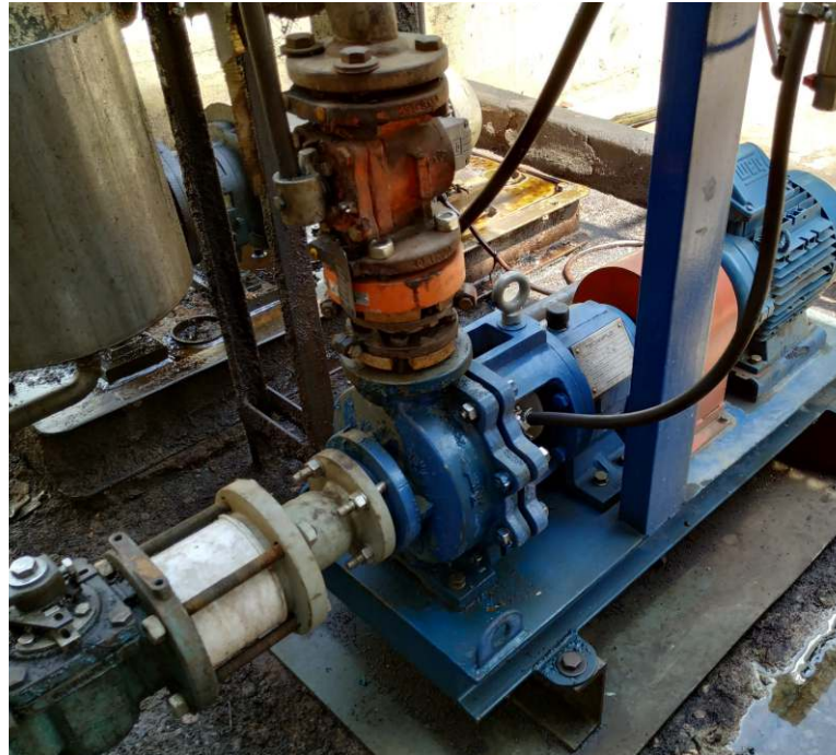
Opciones de bombas centrífugas de proceso para trasvase de fluidos corrosivos, abrasivos, y con sólidos en suspensión.
